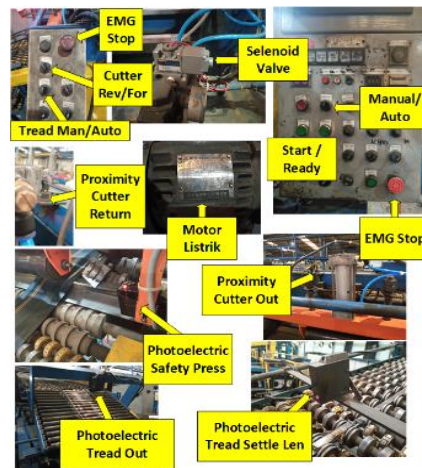
Gambar 11. Tampilan Fisik Input dan Beban Sistem Kontrol
