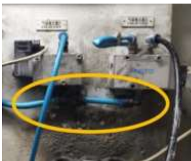
Gambar 7. Panel pneumatic sebelum modifikasi
