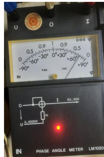
Gambar 46 Pengujian Pengukuran Faktor Daya
