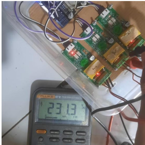
Gambar 44 Pengujian Pengukuran Tegangan
