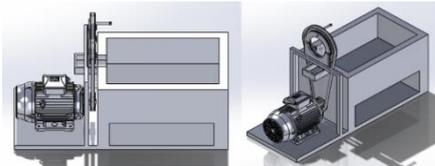
Gambar IX. Desain alat aplikator bitumen
