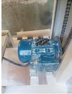
Gambar 28. Pemasangan Motor AC 3 Phase
