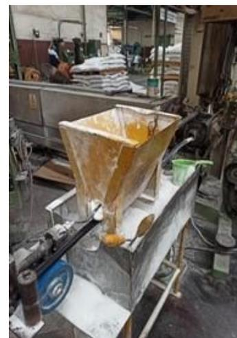
Gambar 4. Mesin Powder Aplikator Mekanik
