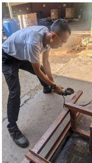
Gambar 24 Pemotongan Dengan Gerinda Tangan
