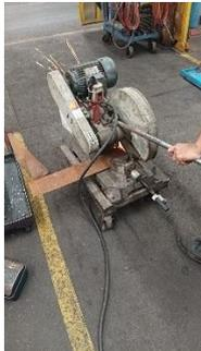
Gambar 23. Pemotongan Dengan Gerinda Duduk
