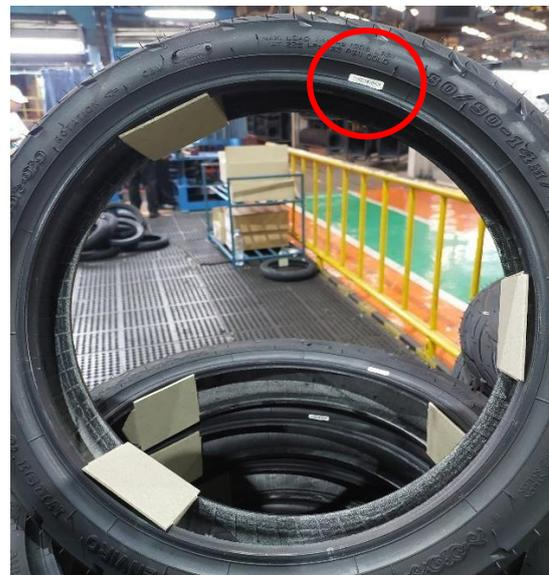
Gambar 27. Posisi Tire Barcode Setelah Modifikasi
