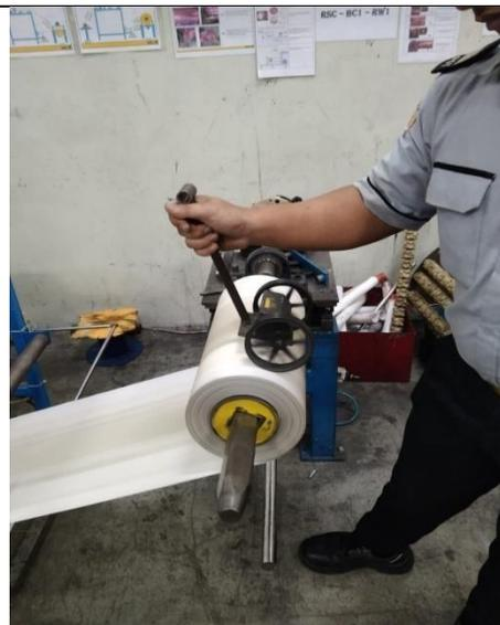
Gambar 22. Pengukuran Manual Pengujian menunjukkan pengukuran panjang kain berfungsi baik dengan toleransi  $\pm 3\%$
