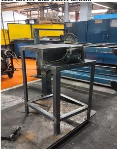
Gambar 10. Kerangka dudukan panel dan motor
