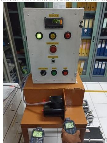
Gambar 13. Pengujian motor pada titik 1734 RPM
