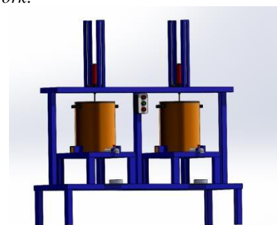
Gambar 12. Desain rancang bangun alat pengaduk cement marking .
