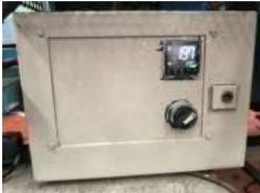
Gambar 12. Panel Sistem Kontrol *Heater* Sesudah Modifikasi
