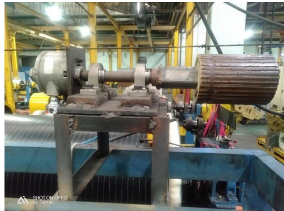
Gambar 14 Kondisi mesin sebelum ditambahkan distance sensor dan pergantian motor listrik
