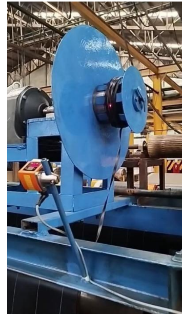
Gambar 16 Kondisi mesin setelah di modifikasi penambahan distance sensor dan pergantian motor
