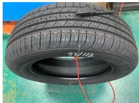
Gambar 5. Pengujian Resistansi Listrik pada Sampel Ban Utuh
