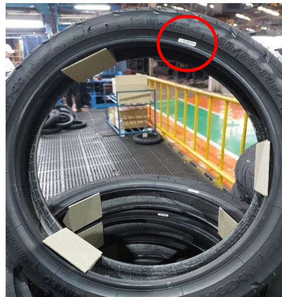
Gambar 27. Posisi Tire Barcode Setelah Modifikasi
