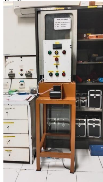
Gambar 12. Alat media kalibrasi tachometer
