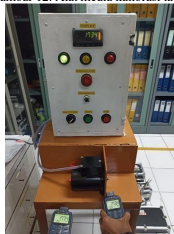
Gambar 13. Pengujian motor pada titik 1734 RPM
