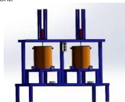
Gambar 12. Desain rancang bangun alat pengaduk cement marking .
