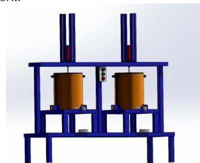
Gambar 12. Desain rancang bangun alat pengaduk cement marking .
