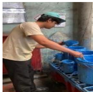
Gambar 1. Proses pengadukan dan penyaringan cement dan solvent .
