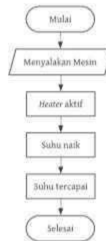
Gambar 10. Sistem Kontrol Sebelum Modifikasi Cara kerja heater cutter ITL sebelum cara kerja modifikasi, yaitu:
