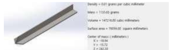
Gambar 13. Tiang Dudukan Sensor ( Sumber : Kajian Penulis )
